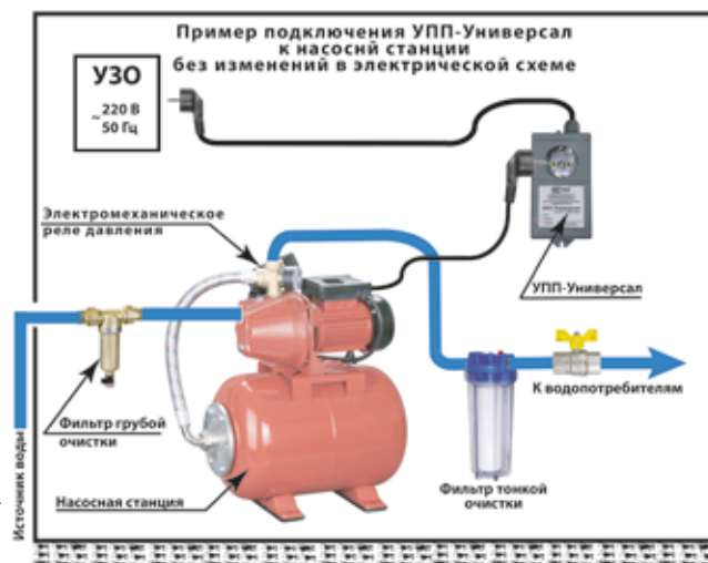
Пример подключения УПП-2,5 после реле давления "Extra Акваконтроль" серий РДЭ или РДС
