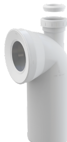
A90-90P40/50A Подключение к напольному унитазу, колено 90° с входом DN 40/50, DN 110, длина 230 мм, PP, белое
