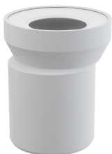
A92 Подключение к напольному унитазу, эксцентрическое 15 мм, DN 110, длина 158 мм, PP, белое
