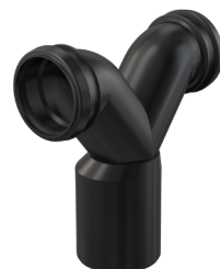
M909 Двойной соединительный отвод 90° для подвесного унитаза, редукция 2 × DN 90 × DN 110, длина 253 мм, PE, чёрное
