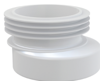
A990 Манжета для напольного унитаза, эксцентрическая 20 мм, 90–110 мм, длина 100 мм, PVC, белая
