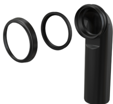
M968 Отвод 90° для подвесного унитаза, Slim, DN 90 × DN 90, длина 285 мм, PE, чёрное
