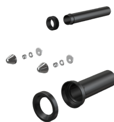
M9000K-DN90 Комплект подключения для подвесного унитаза, DN 90, длина 300 мм, PE, хром
