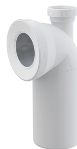
A90-90P50A Подключение к напольному унитазу, колено 90° с входом DN 50, DN 110, длина 230 мм, PP, белое
