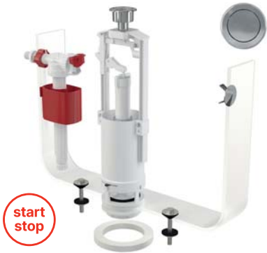
SA2000 3/8" CHROM Выпускной комплект со STOP кнопкой В комплекте: A150-3/8", A2000, заглушка, крепления, уплотнение
