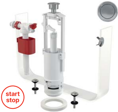
SA2000 1/2" CHROM Выпускной комплект со STOP кнопкой В комплекте: A150-1/2", A2000, заглушка, крепления, уплотнение
