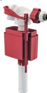
A160PDF-3/8" Впускной механизм с боковой подвод- кой, с задержкой наполнения и метал- лической резьбой для пластиковых и бачков скрытых инсталляционных систем
